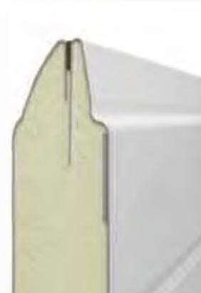
Wärmedämmung, Sicherheit und Stabilität sind uns wichtig. 40 mm dicke Stahlblech-Paneele; mit eingeschäumten Stahl-Verstärkungsbändern, sorgen für hohe Stabilität und hervorragende Wärmedämmung. Das thermisch getrennte Paneel erreicht, zusammen mit der Abdichtung, höchste Wärmedämmstufen – Klasse A Referenztor 3000 x 2700 mm = 8m² Wärmedämmwert nach EN ISO 12567-1 U= 1,2W/m²K
