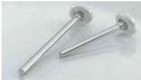
Kugelgelagerte Laufrollen mit langer Achse sorgen für Langlebigkeit und einwandreien Torlauf. Ab 5 m Torbreite verwenden wird sogar doppelt lange Achsen und doppelte Rollenhalter. Diese gewährleisten eine optimale Kraftübertragung und Tragelast, wobei die Achsen sich fliegend im Rollenhalter bewegen können. Auch dies dient dem komfortablen Torlauf auf lange Sicht.
